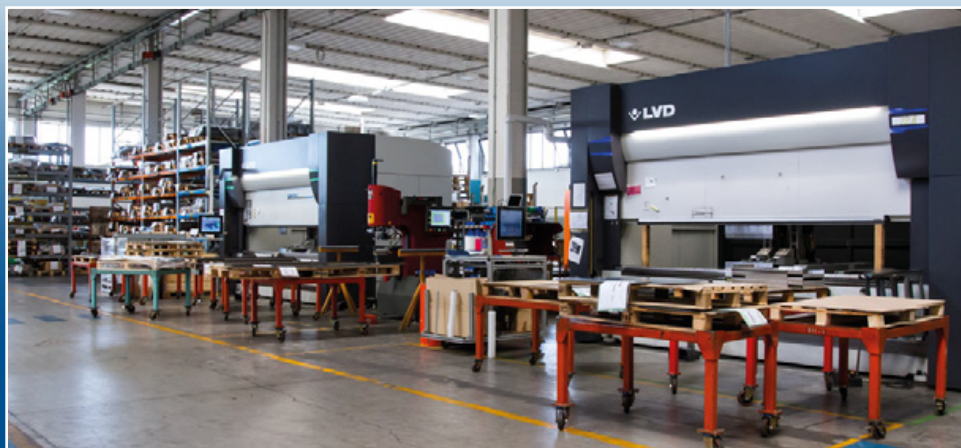
Due presse piegatrici di ultima generazione con cambio utensili in automatico
