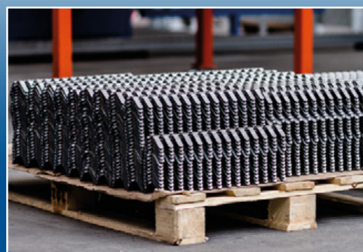
Esempio di pezzi semplici taglio + piega
